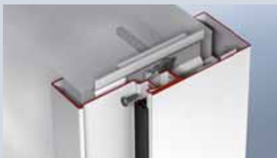
Gegenzargen-Profil 2 der Zarge durch die Dichtungsnut mit Profil 1 verschrauben und mit der Türdichtung überdecken
