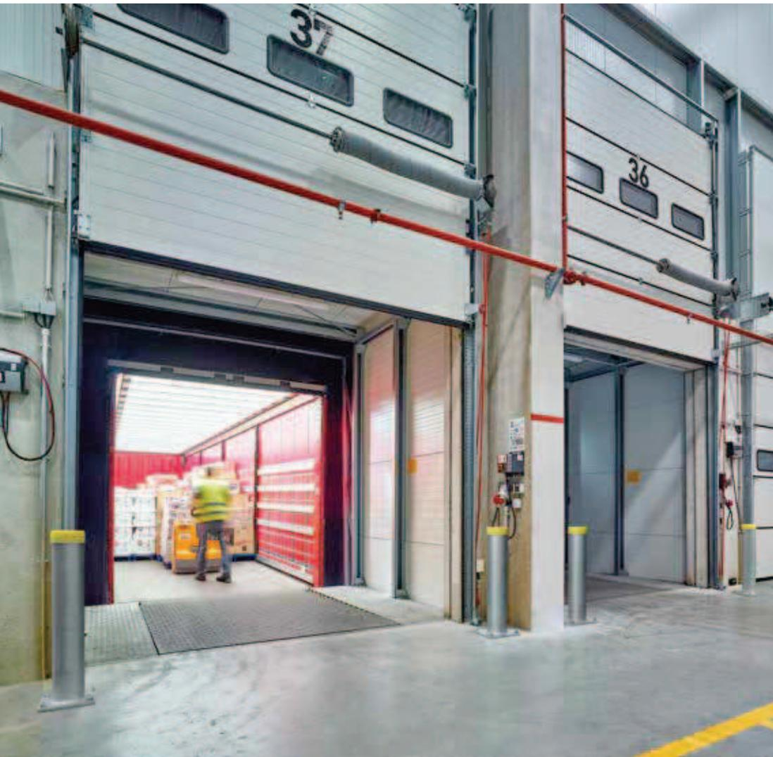
OBEEN LINKS. Vorsatzschleusen in Winkelanordnung sind platzsparende Lösungen bei eingeschränkter Außenfläche.
