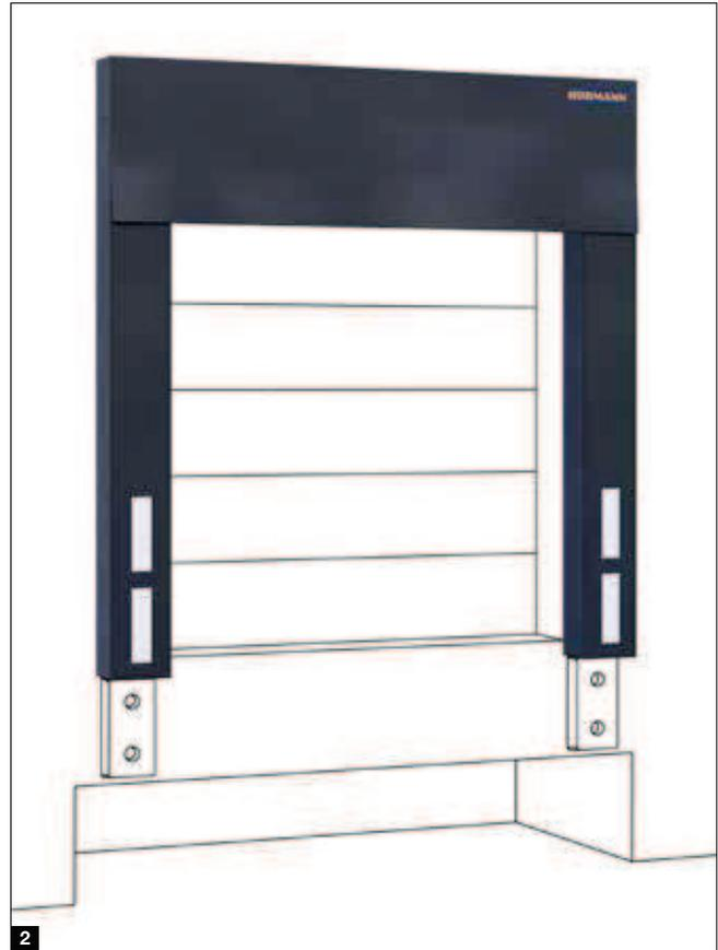
Bei standardisierten Fahrzeugmaßen bieten Kissentorabdichtungen hervorragende Abdichtungsmöglichkeiten. Neben der Passform spielen zwei weitere Aspekte eine Rolle bei der Planung: Bei Kissentorabdichtungen wird nicht nur der Übergang von der LKW-Rückseite zum Gebäude abgedichtet, sondern auch der Luftspalt zwischen LKW und der aufgeschlagenen Tür. Der LKW drückt in die Kissen, wodurch die Kissen in die Ladeöffnung ragen. Kissentorabdichtungen sind für LKW mit Oberklappe daher nicht geeignet.
